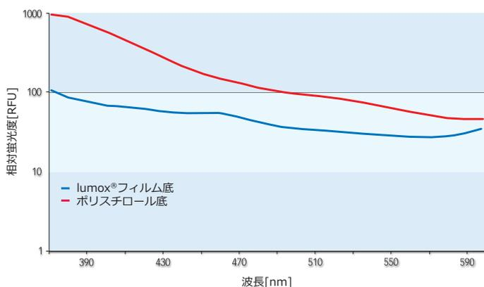
図2 光透過性測定結果。特に200~300nmにおける低波長の検出に優れています
