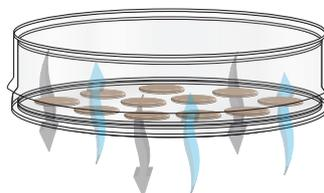
図4 ポリスチレンやガラスなどの従来型培養容器ではガス交換は不可能
